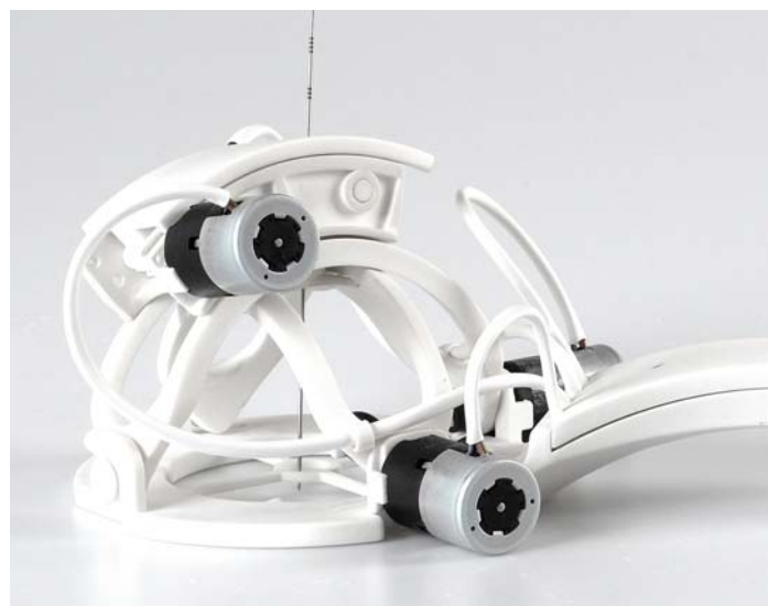
Medizintechnik: Miniaturroboter für die Lungenbiopsie – ausgehend von den CT-Scandaten werden kleinste Tumore präzise angefahren (Robopsy)
