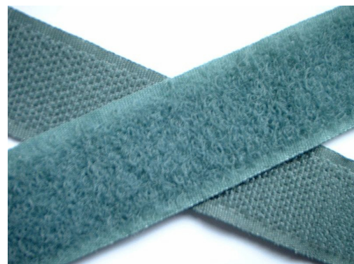
Der Klettverschluss als Beispiel einer durch die Natur inspirierten Entwicklung
