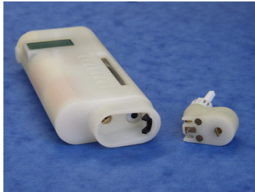
Wiederverwendbares Elektronikteil (links) mit Einweg-Fluidikteil (rechts)
