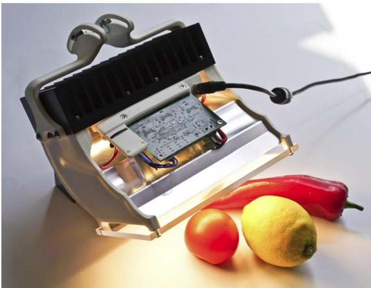
Prototyp einer spektral einstellbaren LED-Mischlichtleuchte
