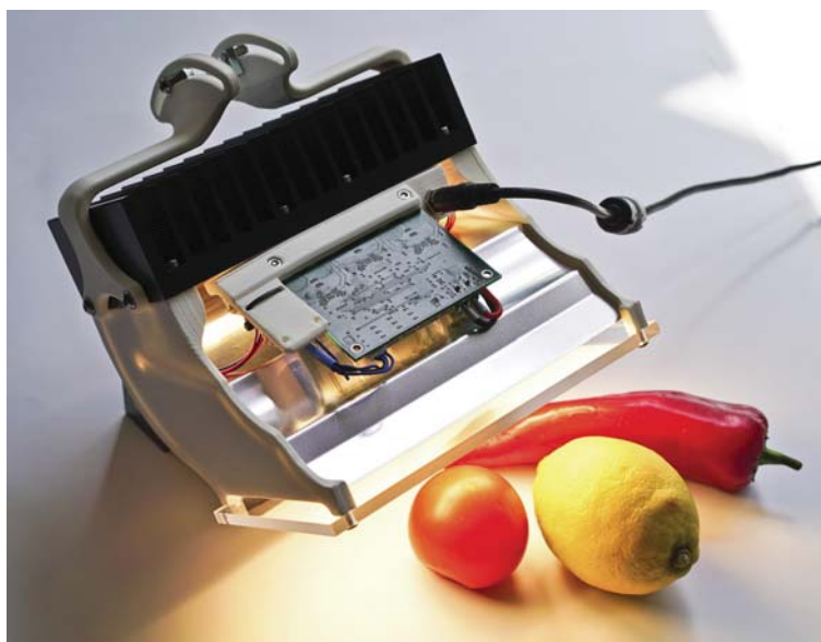
Prototyp einer spektral einstellbaren LED-Mischlichtleuchte
