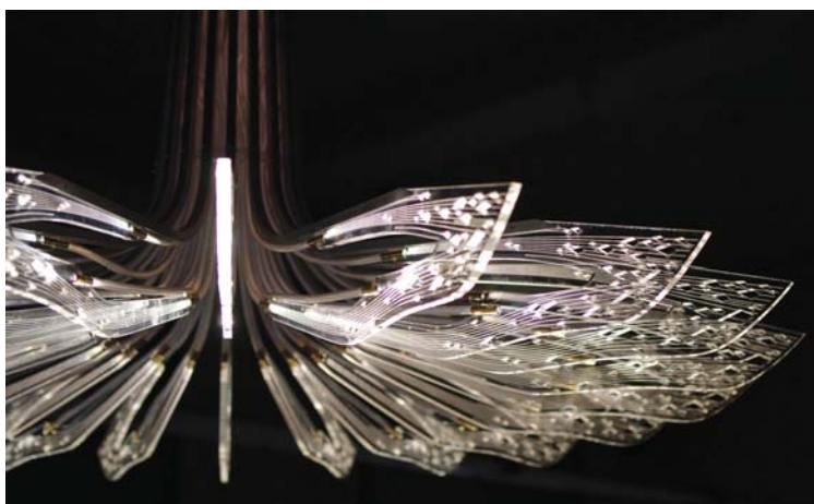
Prototyp eines spektral einstellbaren LED-Kronleuchters
