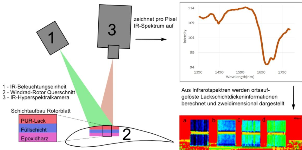
Der etwa 30-minütige Vortrag beginnt mit einer Einführung in die Infrarotspektroskopie. Anschließend wird die Vorgehensweise erläutert, um ein Modell zur Dickenbestimmung der untersuchten Proben zu entwickeln. Die erzielten Resultate werden vorgestellt. Der Vortrag schließt mit einer Diskussion weiterführender Arbeiten.
