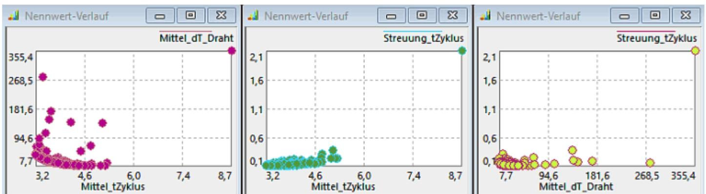
Die einzelnen Lösungspunkte repräsentieren jeweils eine Stichprobe, die im Rahmen der co-evolutionären Optimierungsstrategie berechnet wird. Der Verlauf der Co-Evolution widerspiegelt sich in den Nennwert-Diagrammen der variablen Entwurfsparameter und der Bewertungsgrößen des Experiments:
