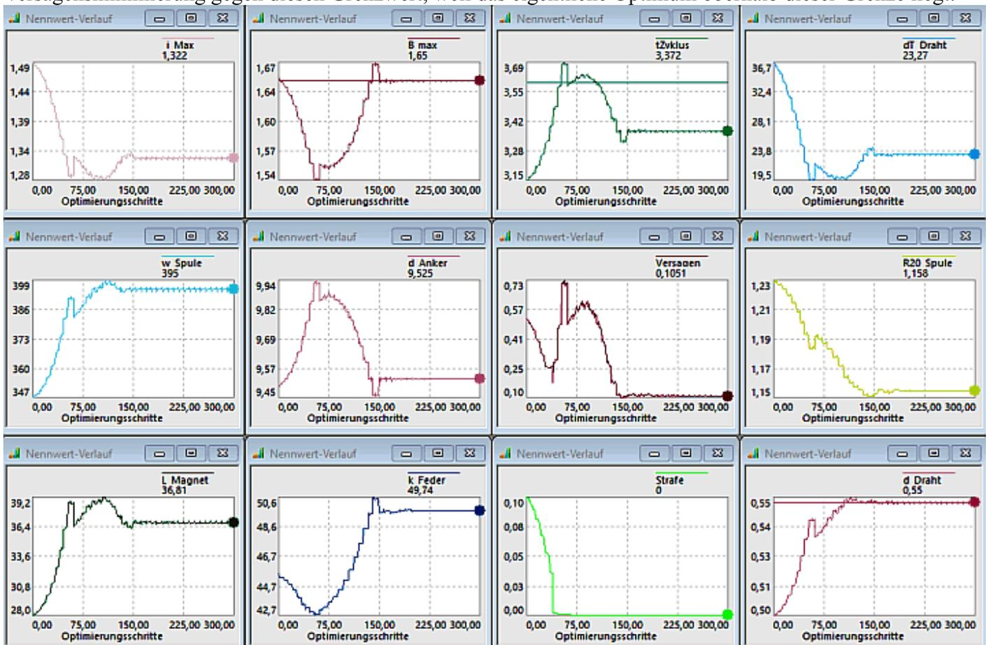
Mit **d\_Draht=0.55 mm** gelangen wir im Beispiel zu einem noch etwas längeren Magneten, da der dickere Draht mehr Wickelraum benötigt:
