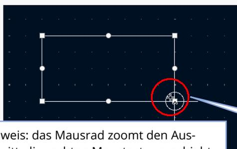
Zeichnen des Leiterplattenumrisses mit 40 mm x 20 mm
