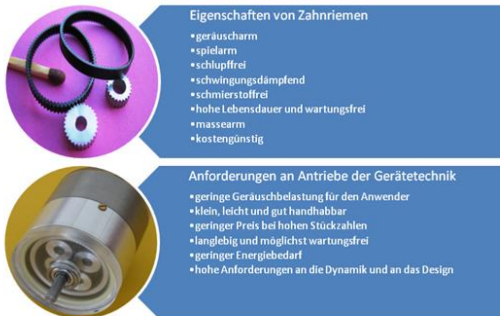
Bild 1: Eigenschaften von Zahnriemen und Anforderungen der Gerätetechnik
